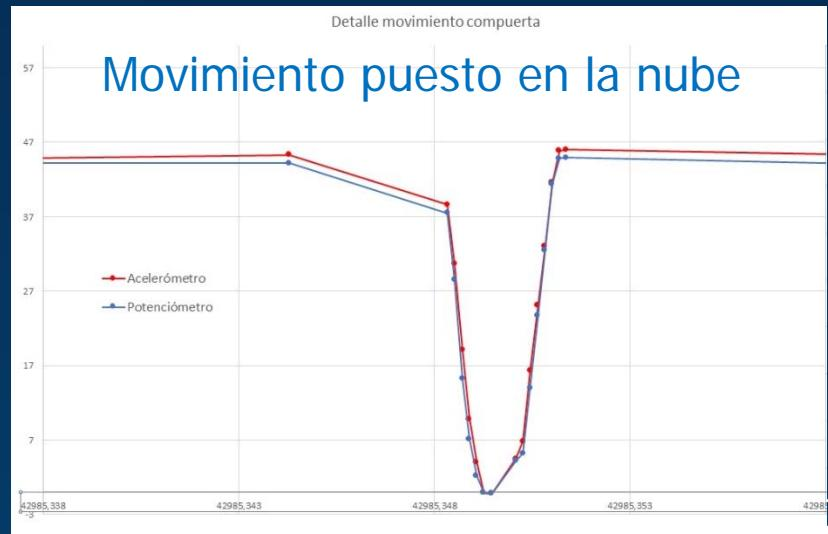
Basado en un sensor potenciométrico o en un IMU (3 acelero. + 3 giróscopos).
